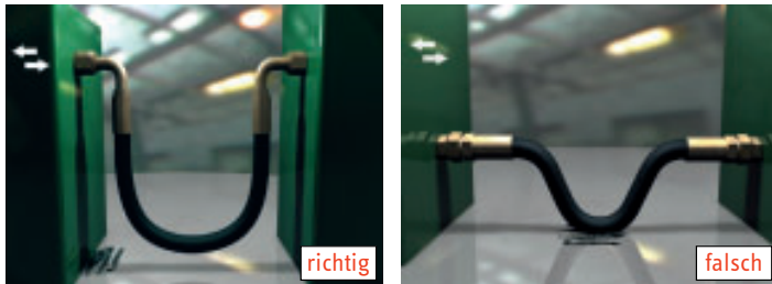
Abbildung 9: Vermeidung von Abrieb durch ausreichende Bewegungsfreiheit
