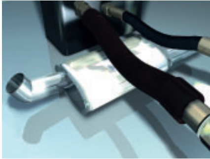
Abbildung 14: Schlauchleitung mit und ohne Hitzeschutz
