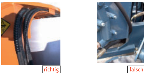
Abbildung 10: Vermeidung von Abknicken oder Scheuern
